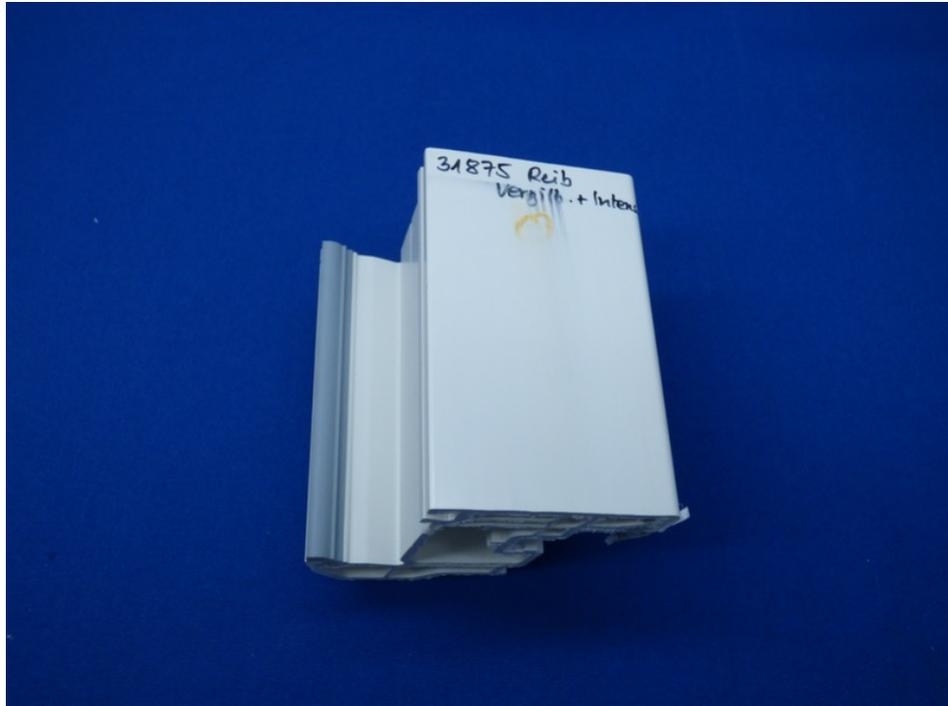
Abbildung 3 – Vergilbungsentferner + Intensivreiniger nach Reibversuch
