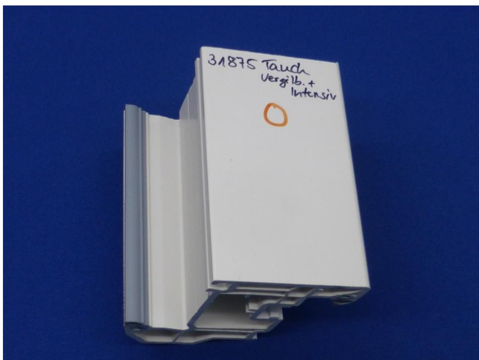
Abbildung 6 – Vergilbungsentferner + Intensivreiniger nach Tauchversuch
